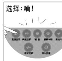
触摸相应功能按键选择对应的功能，对应功能指示灯（或图形指示灯）亮并闪烁，3秒钟后机器自动启动，并伴有“滴滴”两声提示音提示已启动。
